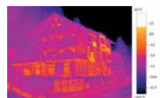
Imagen térmica con testo ScaleAssist
